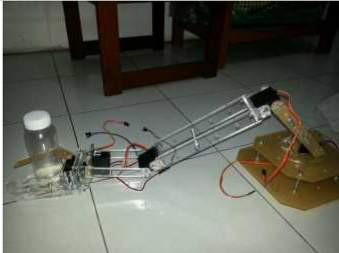
Gambar 3.9 Hasil Rancang Bangun Arm Robot Dengan Gripper
