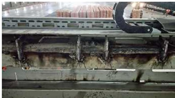
Gambar 2. Rel *layer pusher* retak dan telah di las
