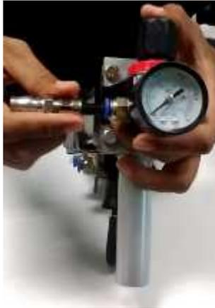
Gambar 3.5. Pemasangan *nozle* dan selang pada regulator
