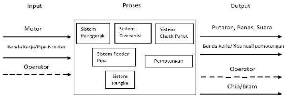
*Gambar 1.4 Fungsi Utama Mesin Pemotong Pipa pada Long-tail*
