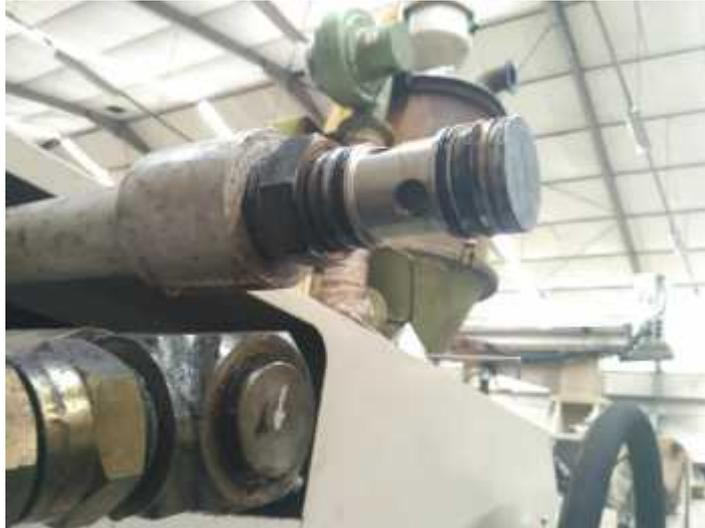
Gambar. 2 kondisi setelah diganti dengan o ring yang baru
