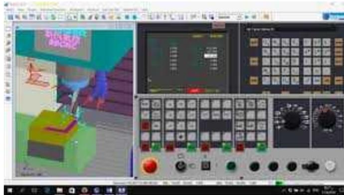
Gambar.3 Contoh Simulasi Proses Milling Pada Software Swansoft
