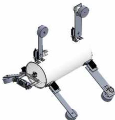
Gambar 2.1 Rancangan Robot Inspeksi Pipa
