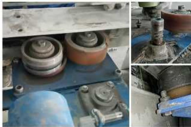
Gambar 1. Roda teflon yang aus dan lepas
